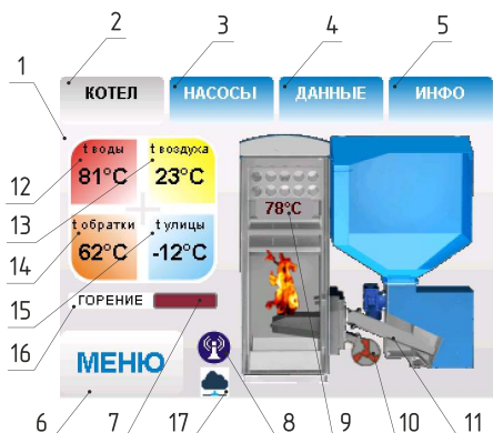
Рис.6 Расположение органов управления и индикации на передней панели пульта
